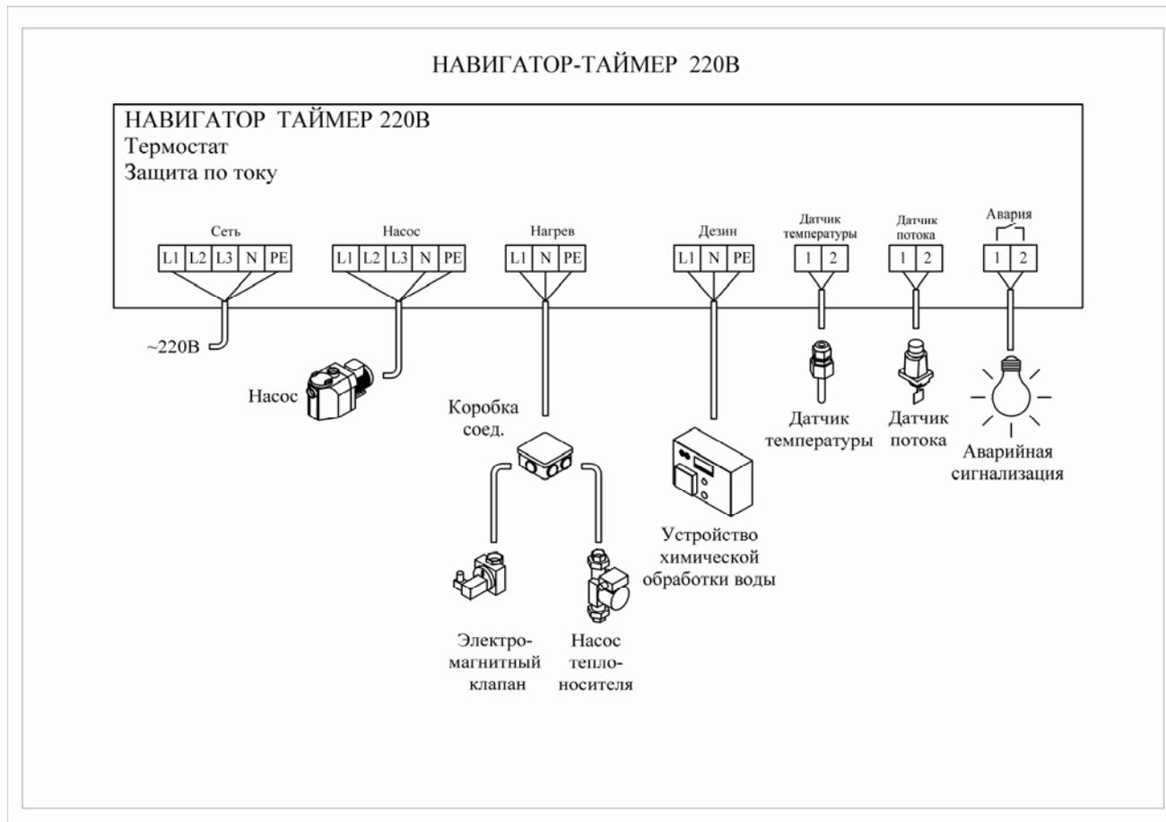
**Подключение насоса и других нагрузок, МОЩНОСТЬ КОТОРЫХ ПРЕВЫШАЕТ 2кВт, производится ТОЛЬКО ЧЕРЕЗ ДОПОЛНИТЕЛЬНЫЕ ЭЛЕКТРОМАГНИТНЫЕ ПУСКАТЕЛИ!**
